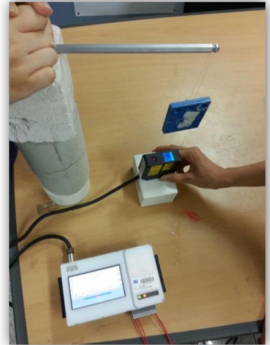
<레이저 변위계를 이용한 모의 재료 물성 실험>
